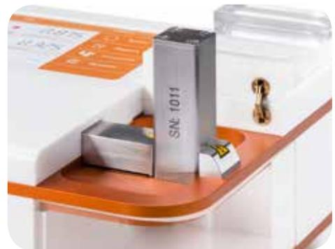
Test funcional para tableta mecánica
