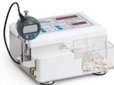
HC 6.2 con medidor de espesor externo y báscula
