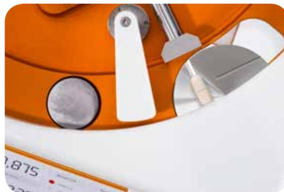
SISTEMA ROTO (disco ranurado manual) para un sencillo posicionamiento del comprimido en el modelo P4
