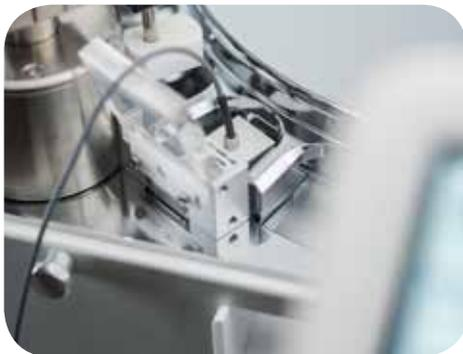
Para la calibración dinámica se coloca célula de carga en la cámara de rotura del sistema de comprobación de comprimidos
